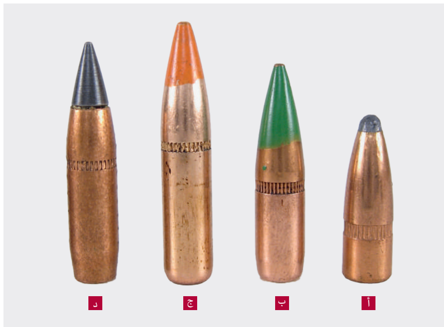
ملاحظة: (أ) رأس أملس مغلف بزين 55 حبة؛ (ب) كرة M855 وزن 62 حبة؛ (ج) خطاطة M856 وزن 62 حبة؛ (د) كرة M855A1 وزن 62 حبة. المصدر: Drake Watkins / ARES
