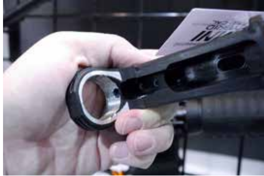
الصورة 7. تحتوي بعض الأجزاء السفلية لعلب المغلاق المصنوعة من البوليمر على جزء معدني صغير لتقوية منطقة الوصل الضعيفة تحديداً. © Nick Leghorn
