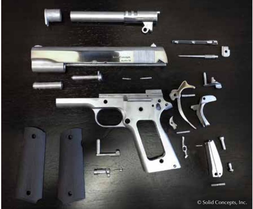
الصورة 3. مكونات مسدس 1911 من إنتاج شركة Solid Concepts Inc، باستخدام تقنية تليبيد المعادن المباشر بالليزر.
