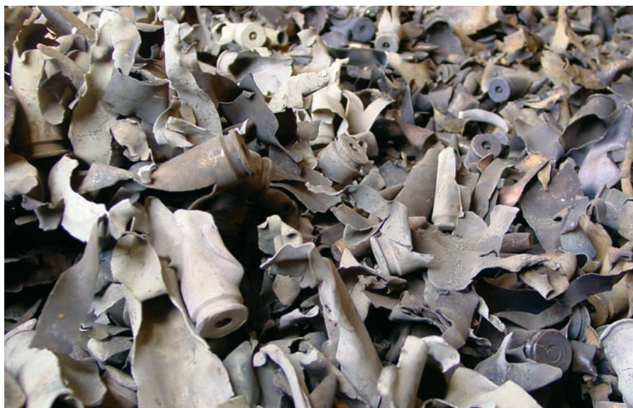
Otpadni metal od municije kalibra 14.5 mm API nakon kontrolisanog paljenja u Albaniji. © NAMSA
