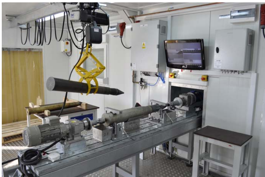
Komponenti i çmontimit të municioneve të sistemit të transportueshëm Planetarium të JAKUSZ-it, duke përpunuar një predhë UBK8 100 mm. © JAKUSZ SZB/2011
