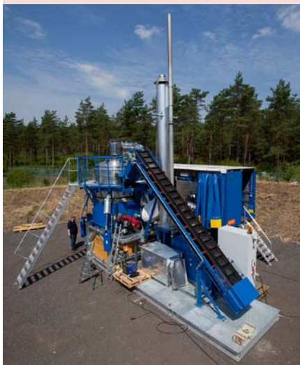
Impianti për çmilitarizimin e municioneve të lëvizshme MEA-2, prodhuar nga Dynasafe Demil Systems AB. © Dynasafe Demil Systems AB/2012
