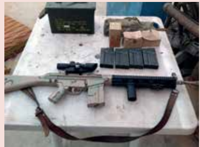
صورة 23/أ بندقية تحميل ذاتي محاكيه لنموذج G3A3. لاحظ المسددة البصرية في التصفيية السوقية بتصميم نهائي مطلي ونهاية طرفية مسيجة
