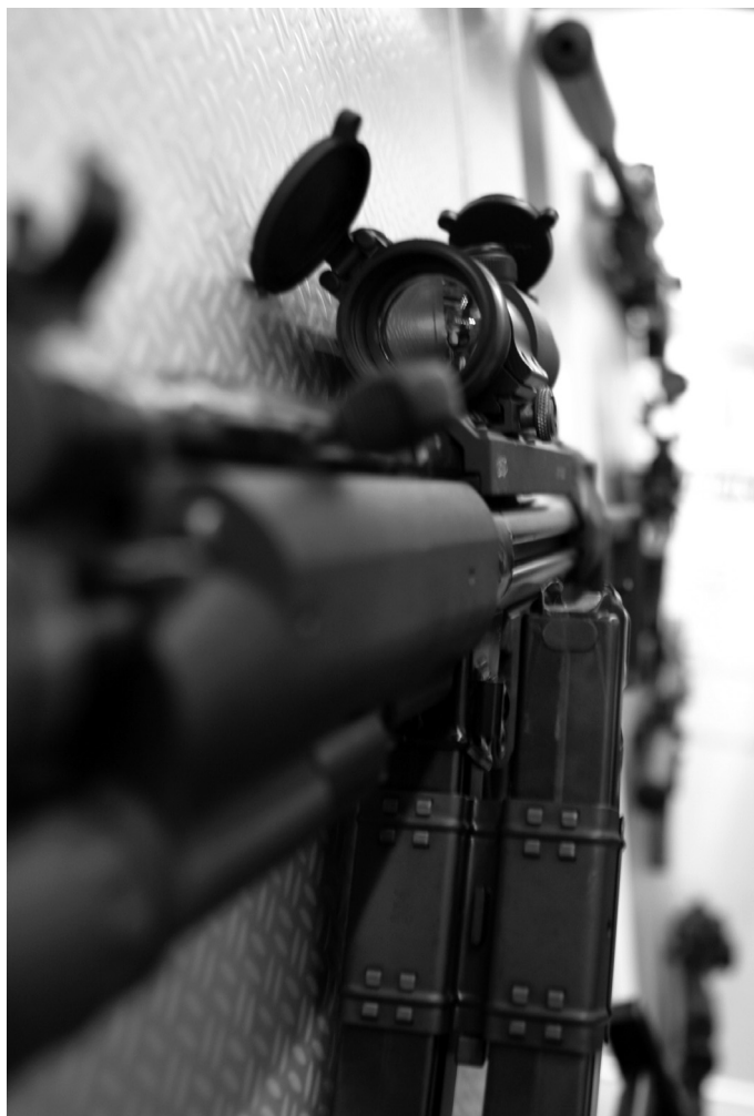
Une mitraillette Heckler & Koch MP5 9 mm modifiée par l'ajout d'accessoires : magazines supplémentaires, coupleur de magazines, projecteur placé sous le canon.
