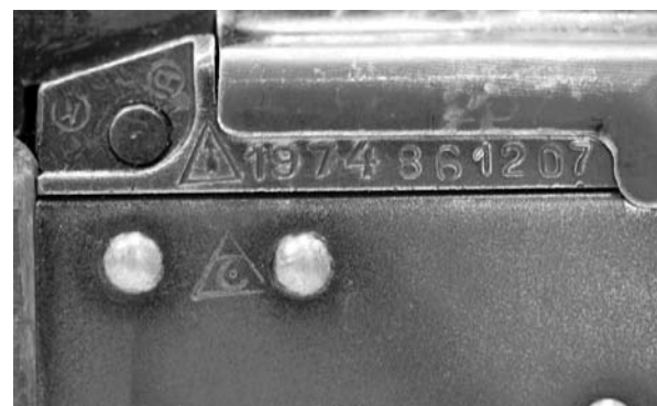
Figure 3.8 Marquage d'importation irakien sur un AKM fabriqué en Russie
