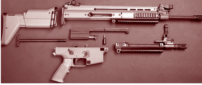
بندقية SCAR-L (نسخة خفيفة من بندقية قتالية الخاصة للقوات) مفككة جزئياً. © وبينزمان دوت كوم
